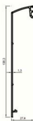
No : 10444 Cam Kúpeşte Kapak Profili 0,650 kg/m
